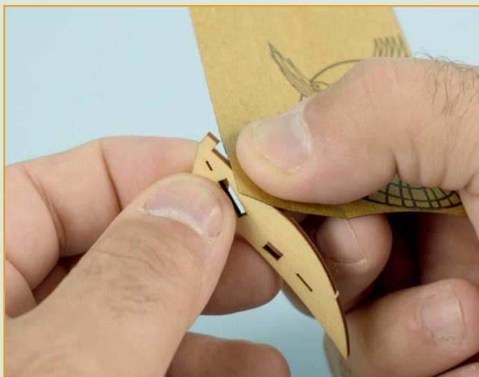
**1** Начинаем сборку первого из четырех двигателей вашей модели «Ильи Муромца». Аккуратно вырежьте по контурам из фанерной пластины детали моторной рамы В1 – В3. Затем зачистите их кромки наждачной бумагой.
