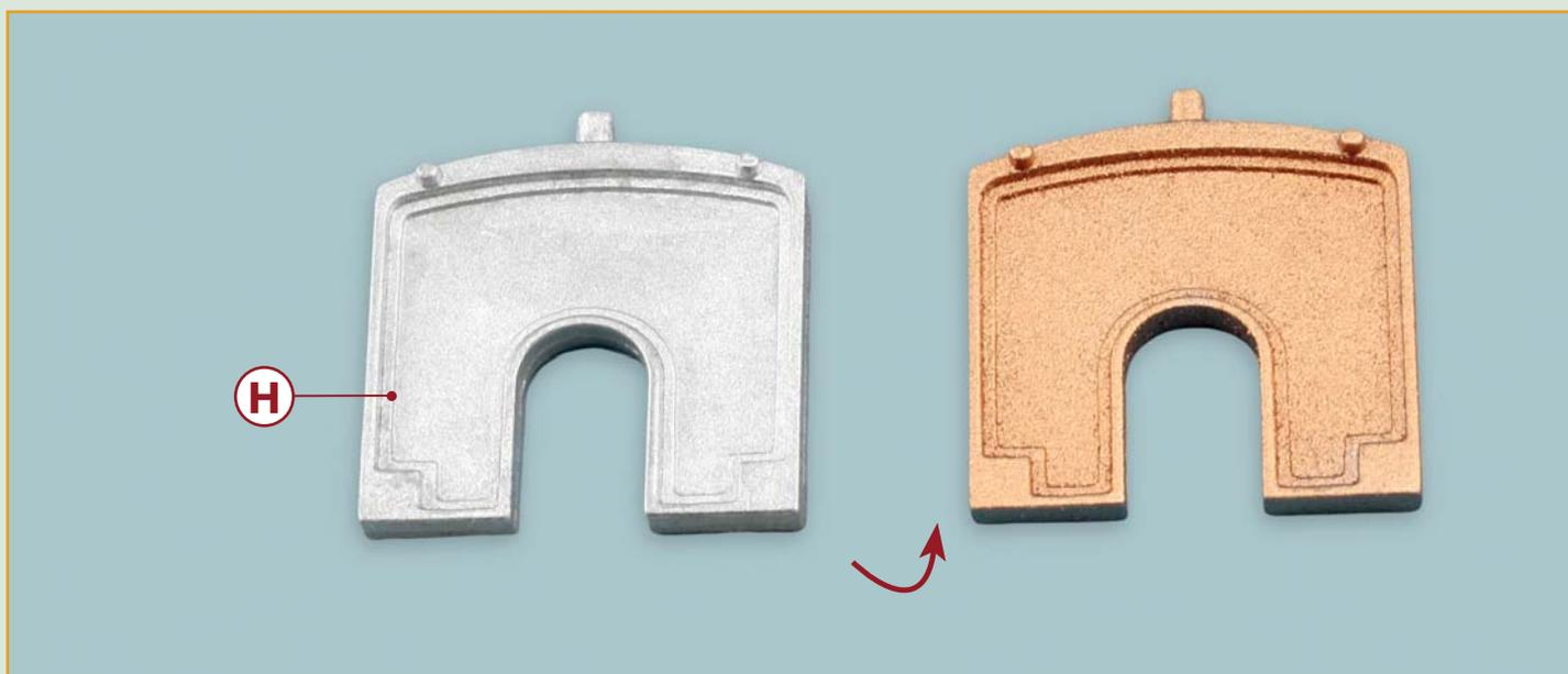
**4** Возьмите радиатор и мягко обработайте его наждачной бумагой, чтобы его поверхности стали ровными и гладкими. Затем покройте радиатор двумя слоями медной краски, полученной с этим номером. Для лучшего сцепления краски с металлом перед покраской деталь желательно обезжирить, протерев тампоном, смоченным спиртом или водно-спиртовым раствором, а затем ватой или бумажной салфеткой.
