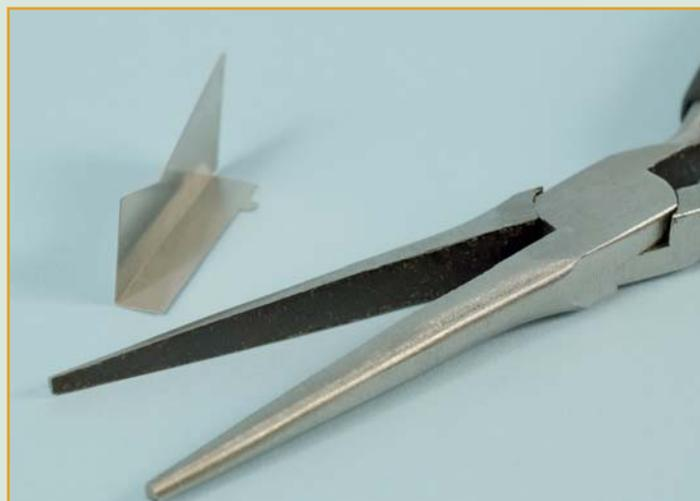
**Совет 1** Используйте прилагаемые к журналу плоскогубцы для придания нужной формы металлическим деталям. Наилучших результатов можно добиться, если кроме плоскогубцев использовать в качестве вспомогательного инструмента металлическую линейку, как это показано на снимке.
