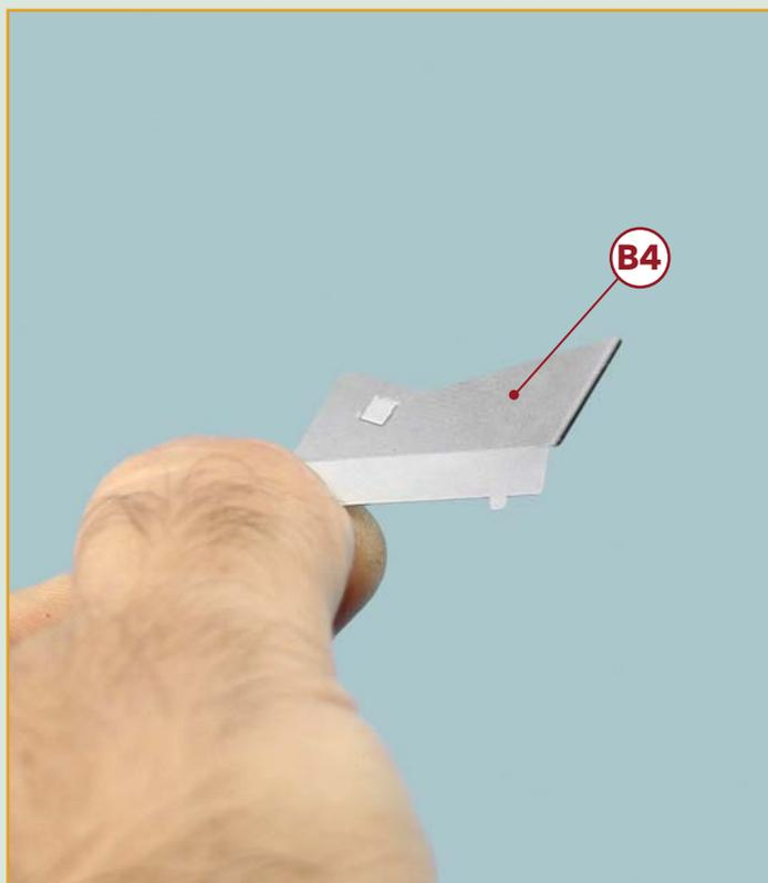
**7** Аккуратно срезав перемычки, извлеките из пластины-заготовки стальные детали опор радиатора В4 и В5. Используя плоскогубцы и металлическую линейку, согните детали по нанесенным на них линиям сгиба, как это показано на снимках.
