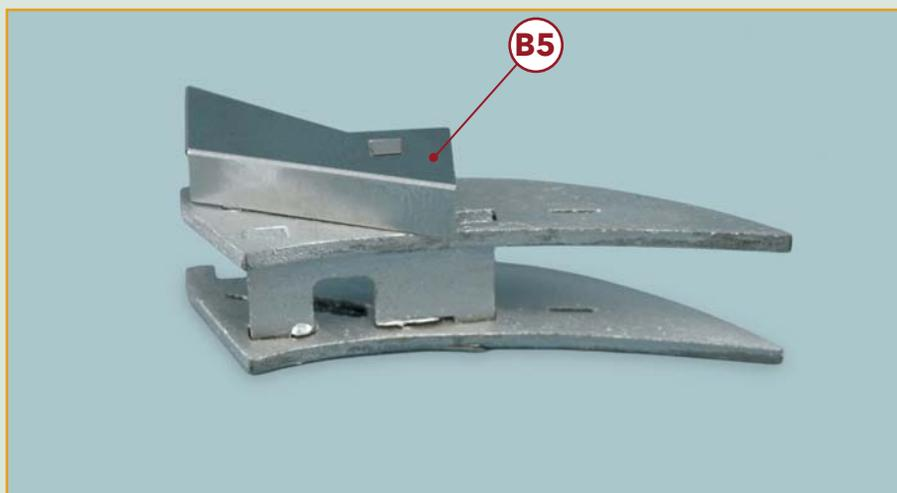
**11** Возьмите собранную ранее моторную раму и приклейте к ней опору радиатора B5, как показано на снимке. Выступ на отогнутой части детали B5 должен до конца войти в прорезь боковой панели B1.
